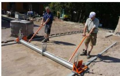
A Régua para Sarrafear o Solo (Optimas Mini Screed) é a ferramenta ideal para preparar uma superfície destinada para a pavimentação. O Mini Screed faz o sarrafeamento da área que irá receber os pavers. O design bem concebido permite a colocação das várias camadas de base (areia, cascalho), fazendo, com isso, a otimização do tempo de preparo da área desejada. O Mini Screed, com suas conexões, chega a uma largura de 4,20 metros.
