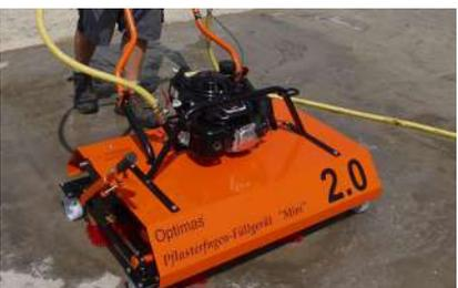
Rejuntadora Automática de Piso Intertravado, Paver e Bloquete da Optimas foi projetada para trabalho em lugares menores e para preencher as juntas de uma só vez. Somente uma junta completamente preenchida é capaz de transmitir forças de uma pedra de calçada para outra e impedir que as pedras de pavimentação sejam deslocadas, mantendo assim a superfície de pavimentação elástica. Pode ser dobrada para o transporte.
